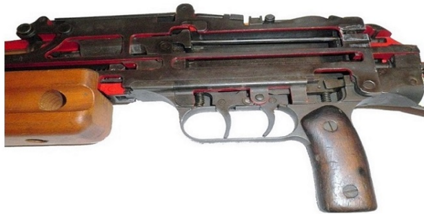
système d'alimentation, culasse, éjecteur et mécanisme de détente
