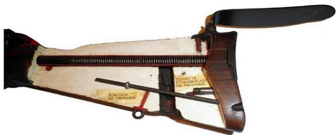
ressort ralentisseur de cadence, clavette d'assemblage et éjecteur de rechange logés dans la crosse
